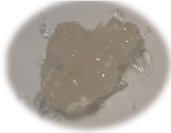
Fig. 1. Ejemplo de grasa lubricante obtenida a partir del electrohilado de material lignocelulósico.
